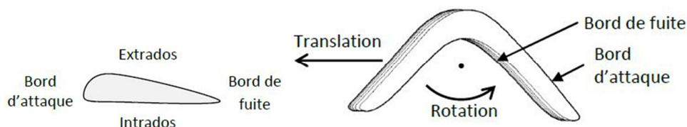
Une pale se comporte comme une aile d'avion. Ici, l'incidence reste voisine de 0, mais les deux côtés de la pale étant différents (intrados plat, et extrados arrondi), la dissymétrie d'écoulement de l'air provoque une force qui se décompose en une **force portante** (perpendiculaire à la pale) et une **force de traînée** dans le sens inverse de la vitesse.
