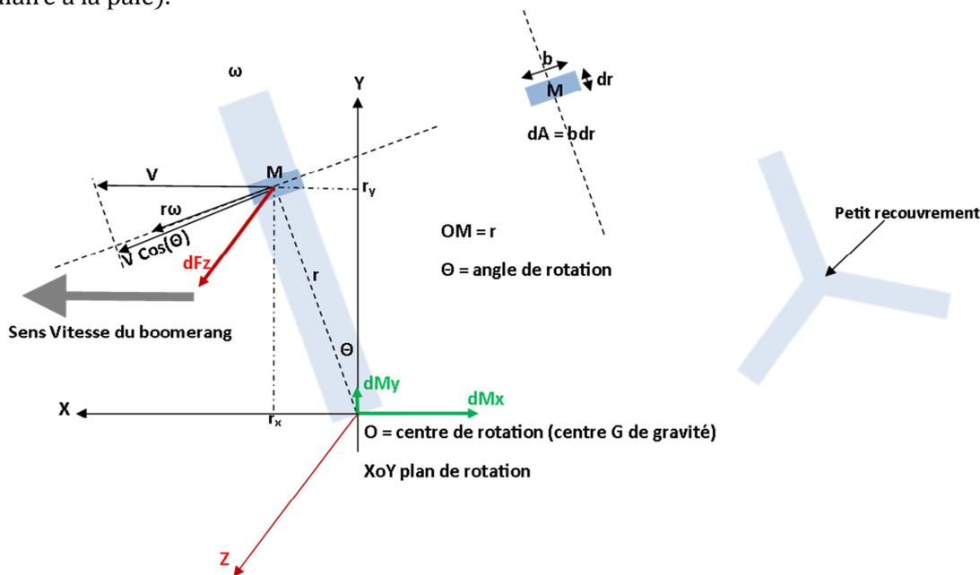
La pale tourne à une vitesse angulaire  $\omega$  par rapport à O. Le profil d'aile  $dA$  se déplace donc à la vitesse  $r\omega$  perpendiculaire au rayon  $r = OM$ . L'angle  $\theta$  correspond à une position particulière de la pale. Cet angle varie de 0 à  $2\pi$  pour un tour complet.
