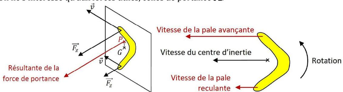
Du fait de la rotation du boomerang, la vitesse de la pale du haut (avançante) est plus grande que celle de la pale du bas reculante. La force  $F_z$  du haut est donc plus grande que la force  $F_z$  du bas. Le centre d'application de la force résultante n'est donc pas appliquée au centre de gravité  $G$  du boomerang, mais un peu plus haut, au point  $P$ . Il se crée donc un **couple** qui tend à faire **basculer horizontalement le boomerang** (à gauche ici).
