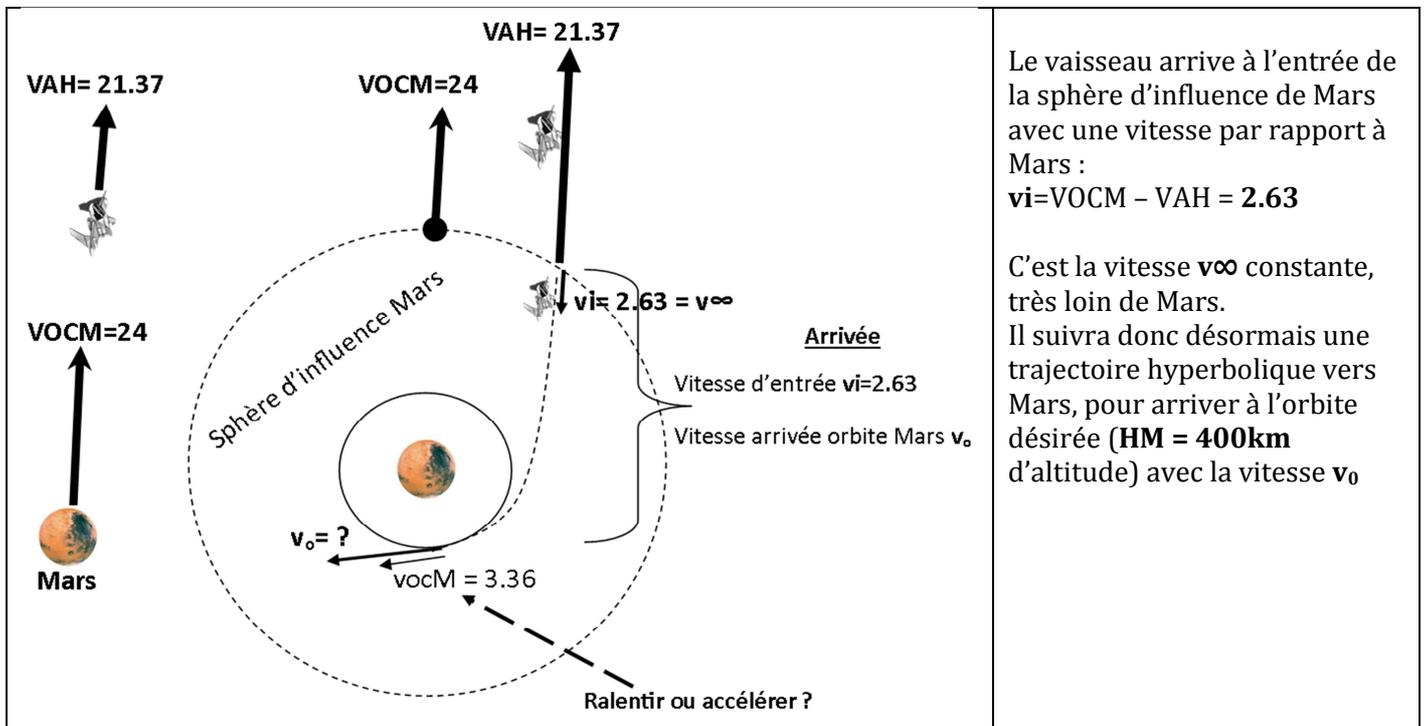
$$\text{Vitesse d'arrivée à l'orbite voulue} = v_0 = \sqrt{vi^2 + \frac{v_{lib} M^2}{1 + \frac{HM}{RM}}} = \sqrt{2.63^2 + \frac{5^2}{1 + \frac{400}{3400}}} = 5.41$$
